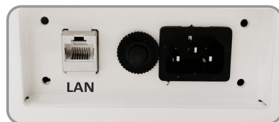
Рис. 3. Розетка подключения к локальной сети
